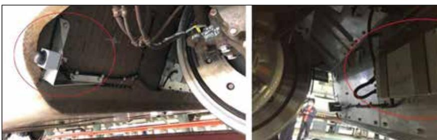
Figura 9 – Esempio di installazione del PC di bordo e dell'antenna GSM-GPS sotto la cassa del veicolo.
