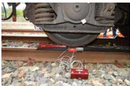
Figura 11 – Strumento di misura del carico statico tra ruota e rotaia (ivmtech.it).
