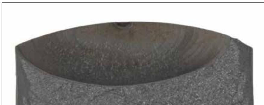
Figura 5 – Cricca, aperta dopo una prova di propagazione. Nell'area esterna centrale si trova l'intaglio iniziale.
