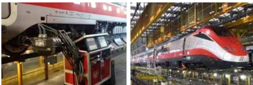
Figura 2 – Boro-sonda UT in funzione durante il controllo di un assile di un treno in deposito.
