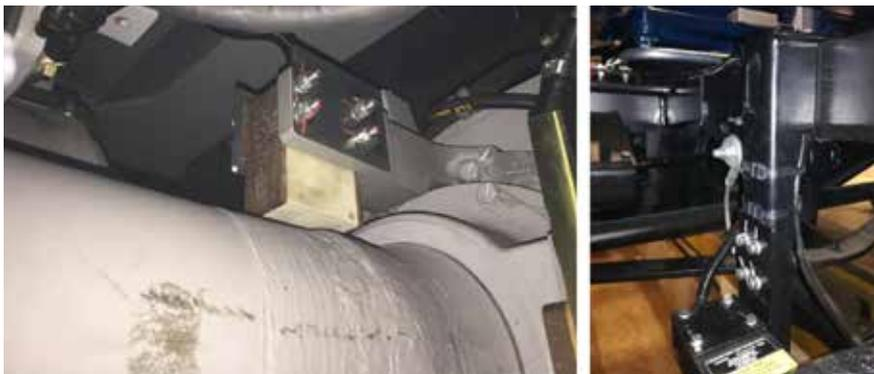
Figura 7 – Testa induttiva fissata alla cassa del riduttore, a sinistra; al telaio del carrello nel caso di una sala portante, a destra.
