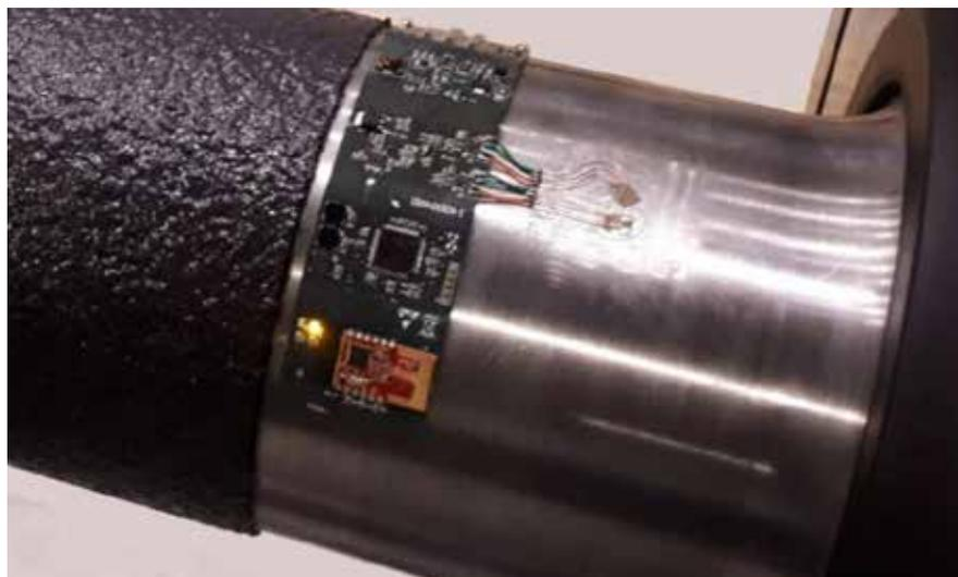
Figura 6 - Scheda telemetrica flessibile installata sull'assile prima della protezione finale con resine specifiche.
