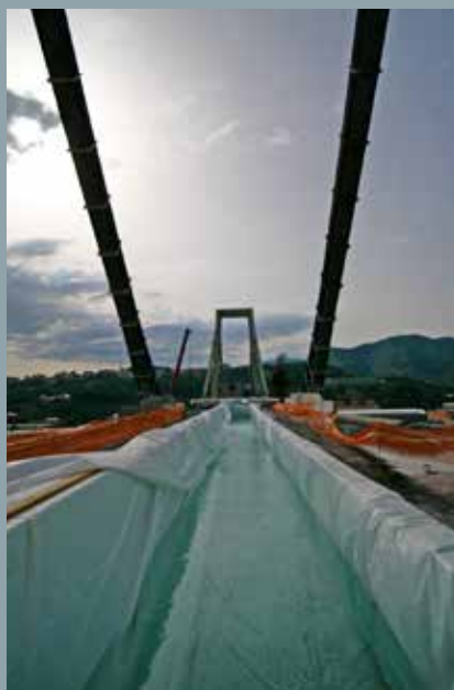
^ Figura 14: Vasche d'acqua minate strategicamente poste sull'impalcato
