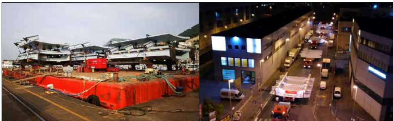
Figura 1: Trasporto “megablocchi” in chiatta e in strada
